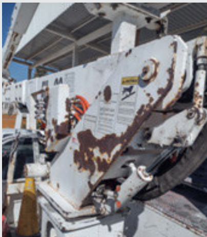
Figura 3. Brazo metálico presentando herrumbre en su estructura.
