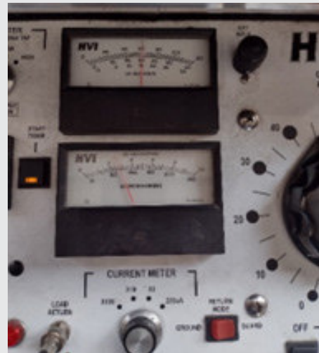
Figura 7. Inyección de voltaje y corriente de fuga durante la prueba dieléctrica a un equipo hidráulico de canastilla sencilla.
