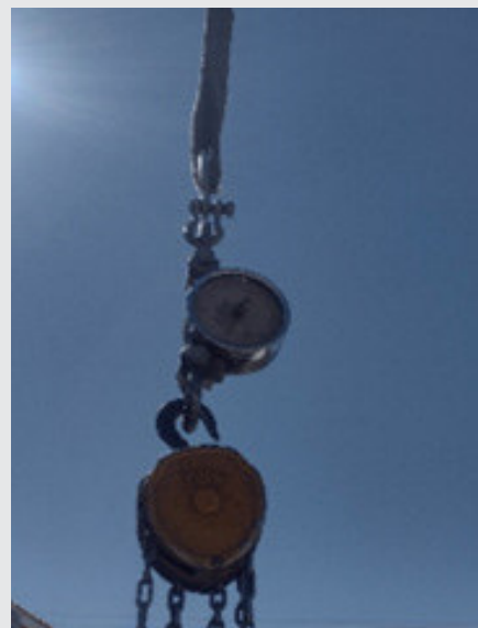
Figura 10. Aplicación de la carga generando un esfuerzo al equipo para ensayo de emisión acústica. Fuente: Elaboración propia.
